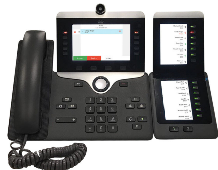
Figura 11: Módulo de expansão de teclas do Telefone IP Cisco 8865 com ecrã duplo
