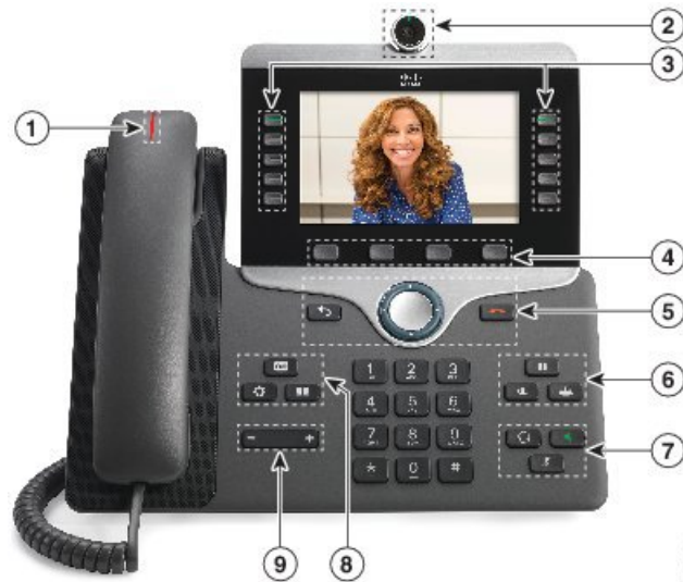
איור 7. לחצנים וחומרה של טלפון Cisco IP מדגם 8845
