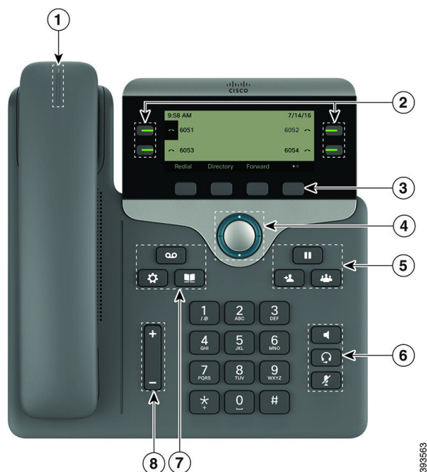
Obrázek 2: Tlačítka a funkce zařízení řady Cisco IP telefon 7800
