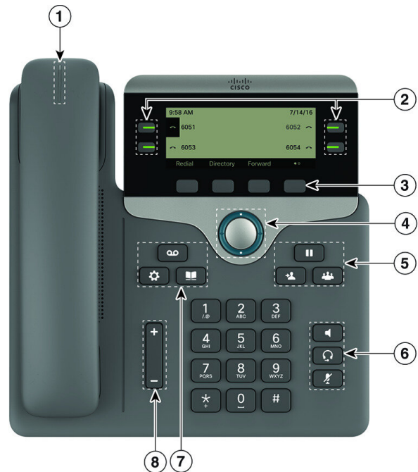
Фигура 2: Бутони и функции на Cisco IP телефон серия 7800
