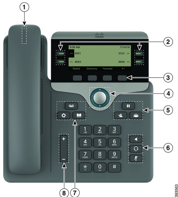
Figura 1: Funzionalità e pulsanti di Cisco IP Phone serie 7800
