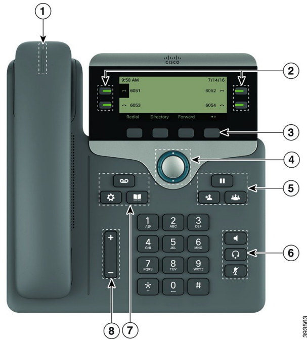
图 1: Cisco IP Phone 7800 系列按键和功能
