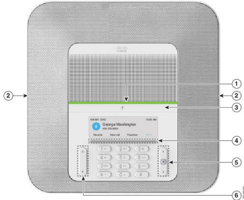
Şekil 2: Cisco IP Konferans Telefonu 8832 Düğmeleri ve Özellikleri
