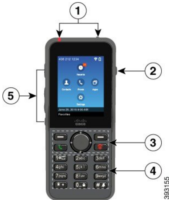
Obrázok 2: Bezdrôtový telefón IP Cisco 8821 Tlačidlá a hardvér
