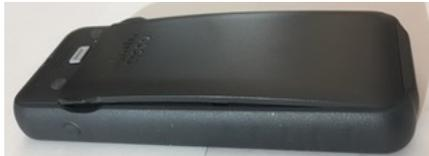
La batería también se puede alargar o ensanchar, lo que dificulta la tarea de quitarla. No utilice ningún instrumento para hacer palanca a fin de sacar la batería.
