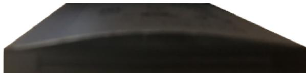
En la siguiente imagen, se muestra una batería hinchada en el compartimento de la batería. Observe que la batería no está al nivel de las paredes del compartimento alrededor del perímetro de la batería.
