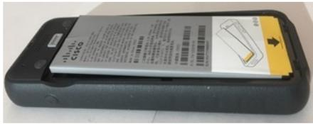
En la siguiente imagen, se muestra la misma batería hinchada cuando se pone la cubierta. Observe que el centro de la cubierta está arqueado. Los cierres en la parte central de la cubierta no se podrán conectar fácilmente.
