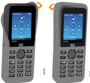
**Paso 4** Si la abertura de la pantalla se enrolló, desenróllela hasta que quede plana.
