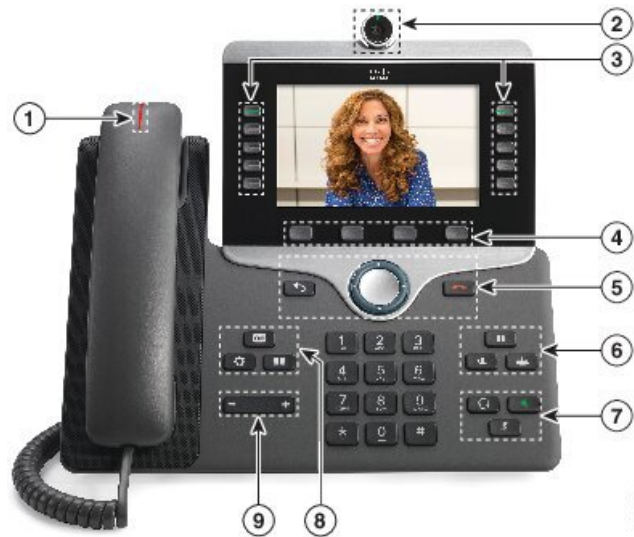
Мал. 3: Кнопки та обладнання IP-телефона Cisco 8845
