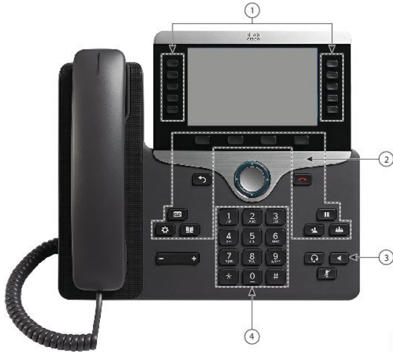
Мал. 8: Функції для людей із порушеннями опорно-рухового апарату – показано на прикладі IP-телефона Cisco 8861
