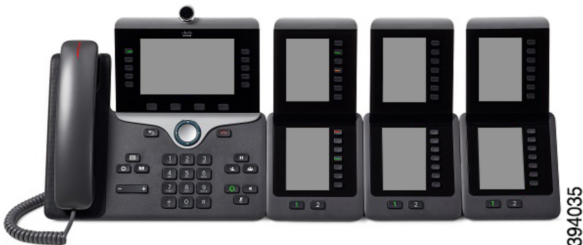
Мал. 27: IP-телефон Cisco 8865 із трьома клавішними приставками для IP-телефона Cisco 8800
