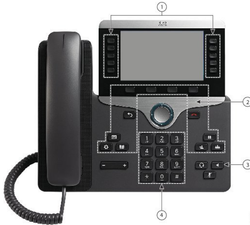
Rysunek 8: Funkcje przeznaczone dla osób z upośledzeniem ruchowym — na ilustracji telefon IP Cisco 8861
