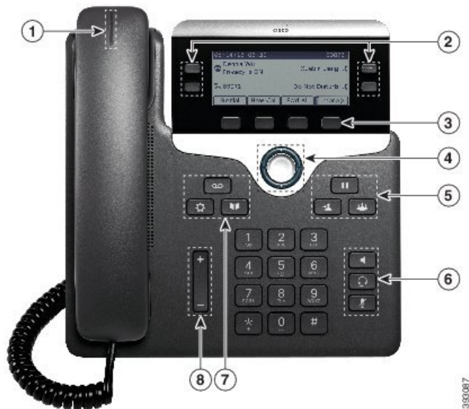
Figura 3: Botones y funciones del teléfono IP de la serie 7800 de Cisco
