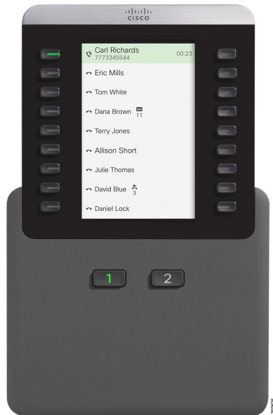
Figur 20: Utvidelsesmodul for Cisco IP Phone 8800 i énkolonnemodus
