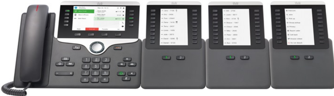
الشكل 18: هاتف Cisco IP Phone 8861 بثلاث وحدات توسيع أساسية مخصصة لسلسلة هواتف Cisco IP Phone 8800
