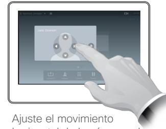
Ajuste el movimiento horizontal de la cámara, el zoom y la inclinación.
