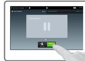
Toque **Intercambiar** para alternar entre ambos y **Transferir** para conectarlos a ambos, mientras usted se retira de la conversación.
