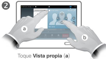
Toque **Vista propia (a)** y ajuste el **Movimiento horizontal, Inclinación y Zoom (b)**.
