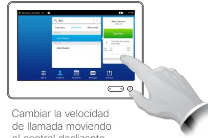
Cambiar la velocidad de llamada moviendo el control deslizable.
