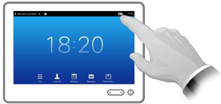
Toque **Cámara** para invocar el menú de ajuste de cámara.
