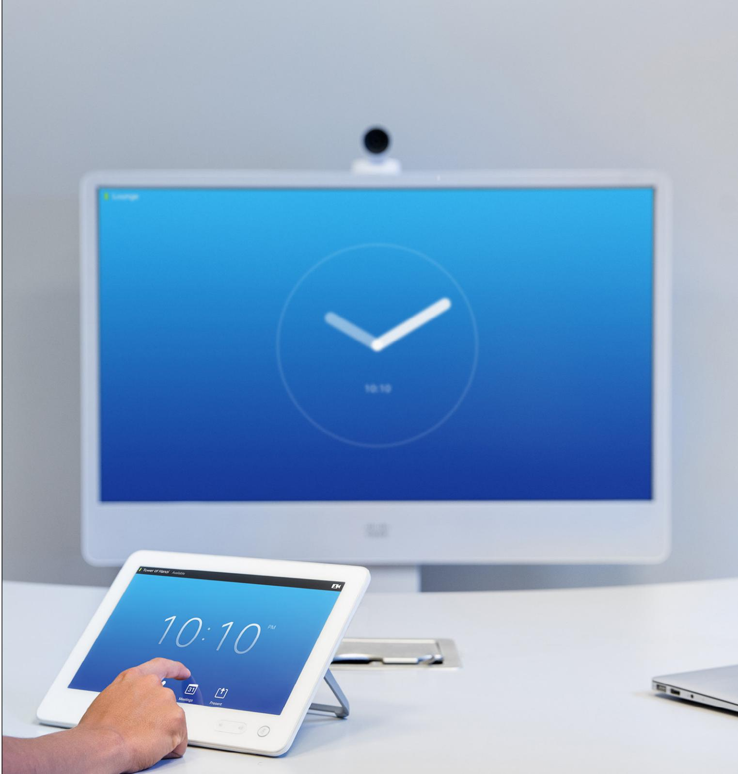
Los terminales de vídeo cuyo uso se describe en este manual se pueden configurar mediante el controlador de pantalla táctil o a través de su interfaz web. Para obtener acceso completo a todos los parámetros que se pueden ajustar, se debe usar la interfaz web. El controlador de pantalla táctil solo ofrece acceso a un conjunto limitado de parámetros.
