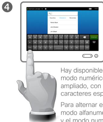
4 Hay disponible un modo numérico ampliado, con caracteres especiales. Para alternar entre el modo alfanumérico y el modo numérico ampliado, toque en la tecla de la esquina inferior izquierda del teclado.
