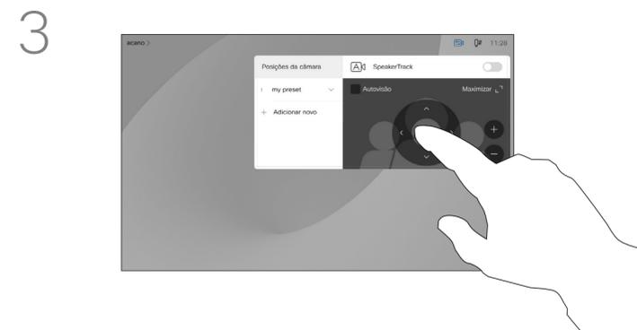
Ajuste **Pan, Tilt e Zoom**, conforme necessário.
