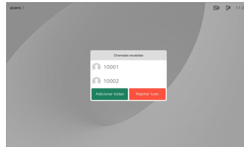
Se o seu dispositivo permitir a receção de várias chamadas em simultâneo, pode optar por adicionar todas ou recusar todas.
