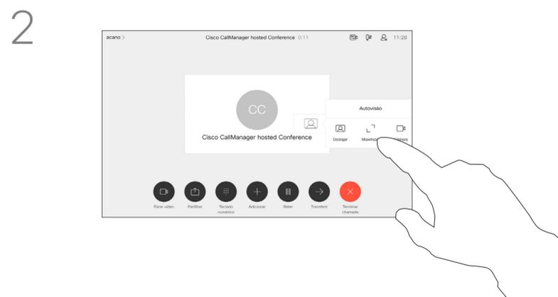
Toque em **Maximizar**, para redimensionar a imagem da visualização própria, conforme indicado. Repita o procedimento para minimizar.
