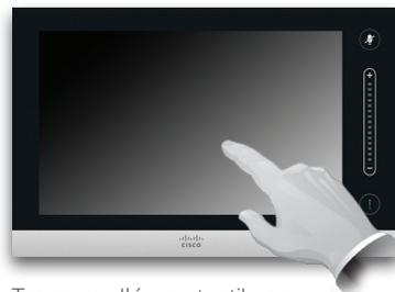
Tapez sur l'écran tactile pour réactiver le système si besoin.
