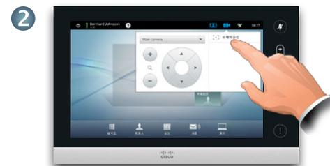
2 如图所示点按新增预设位。如图所示，所有已存在的摄像机预设位将显示在列表中。
