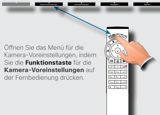
Öffnen Sie das Menü für die Kamera-Voreinstellungen, indem Sie die **Funktionstaste** für die **Kamera-Voreinstellungen** auf der Fernbedienung drücken.
