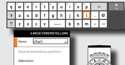
Vergeben Sie einen Namen für die neue Voreinstellung. Navigieren Sie in der Tastatur mithilfe der **Pfeiltasten** und drücken zur Auswahl eines Zeichens die **✓ Taste**. Über die entsprechenden Tasten können Sie auf Sonderzeichen und Ziffern zugreifen.
