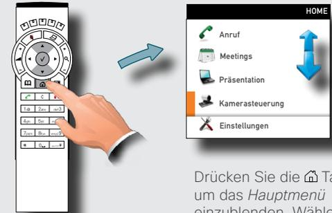
Drücken Sie die Taste, um das *Hauptmenü* einzublenden. Wählen Sie *Kamerasteuerung*. Drücken Sie die ✓ Taste.
