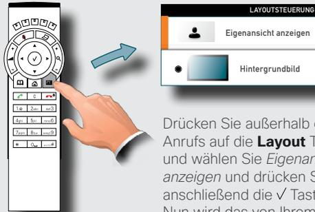
Drücken Sie außerhalb eines Anrufs auf die **Layout** Taste und wählen Sie *Eigenansicht anzeigen* und drücken Sie anschließend die ✓ Taste. Nun wird das von Ihrem System ausgehende Videosignal angezeigt.
