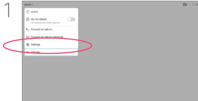
Pour accéder au menu *Paramètres*, naviguez jusqu'à l'angle supérieur gauche de l'écran et appuyez sur le bouton **OK** de la télécommande. Allez ensuite à *Informations système* (avant-dernier élément du menu) et appuyez de nouveau sur **OK**.
