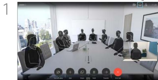
1 Selfview étant activé ou dans une mise en page d'incrustation d'image dans l'image, accédez à *Mise en page* dans le coin supérieur droit, puis appuyez sur **OK** de la télécommande. L'icône Disposition n'apparaît que dans les cas pertinents.
