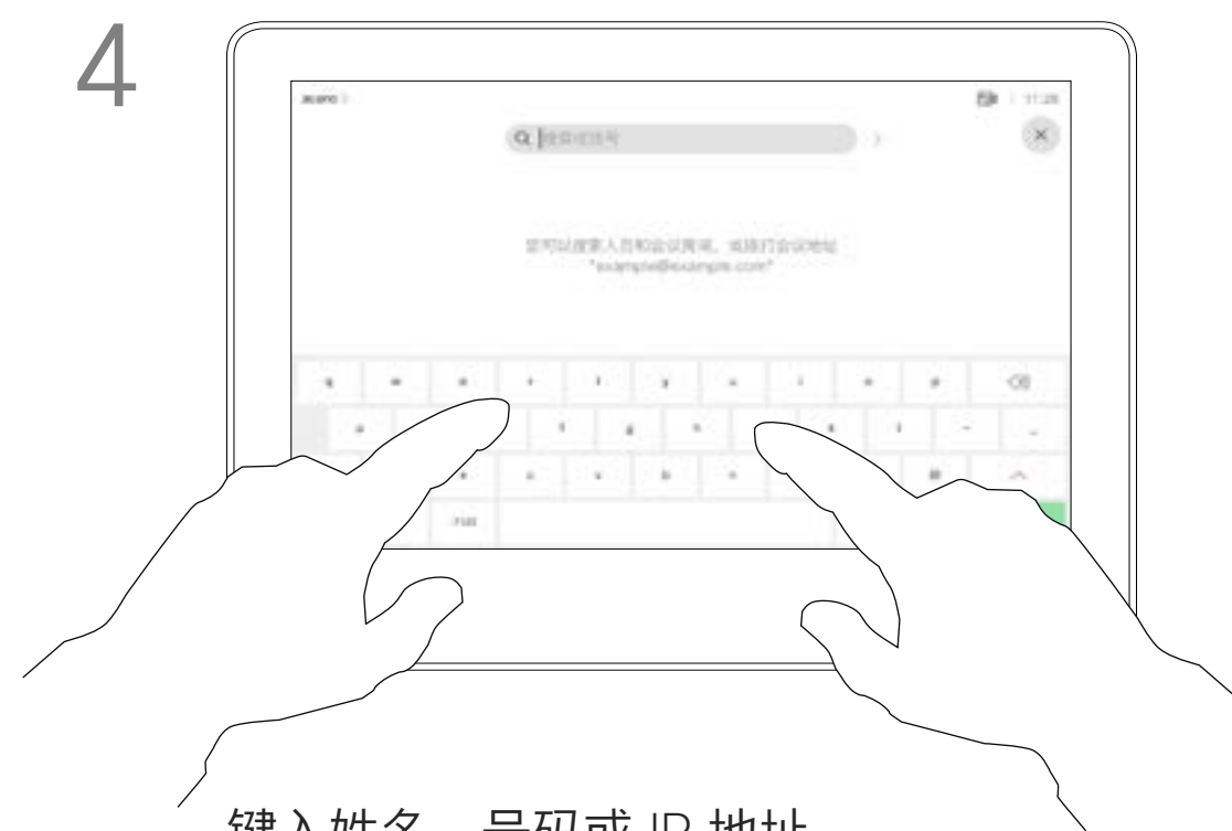
4 键入姓名、号码或 IP 地址。 在您键入时会显示匹配项。 点击并按住 *，键入 IP 地址中使用的点号。
