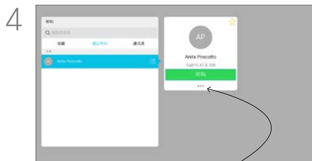
4 使用遥控器上的光标键导航到更多字段 (...), 然后按确定。
