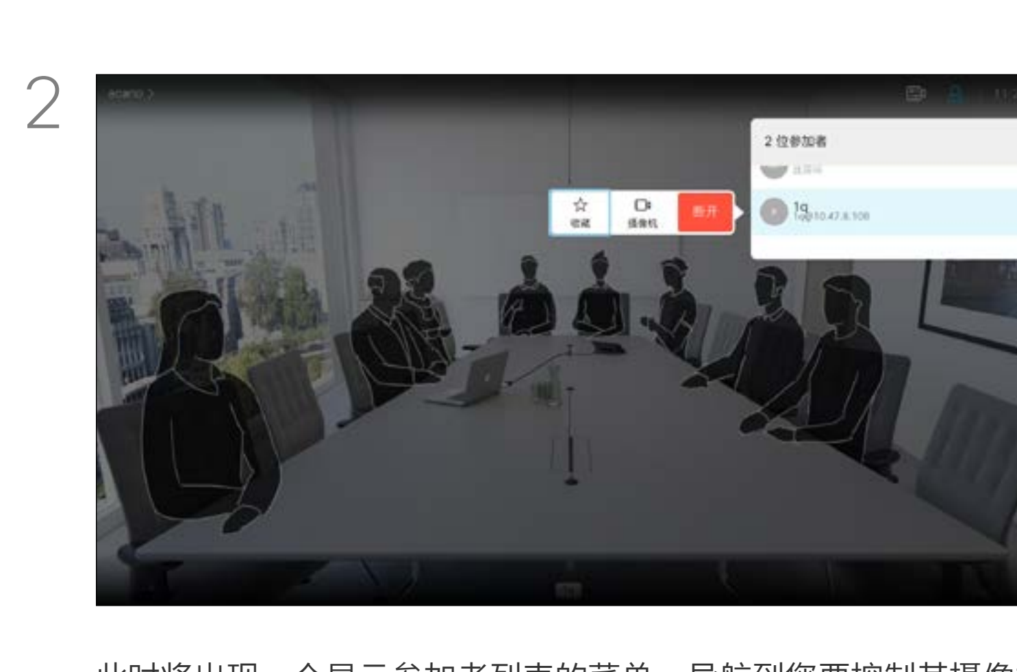
此时将出现一个显示参加者列表的菜单。导航到您要控制其摄像机的参加者，然后按遥控器上的确定。此时将显示子菜单。
