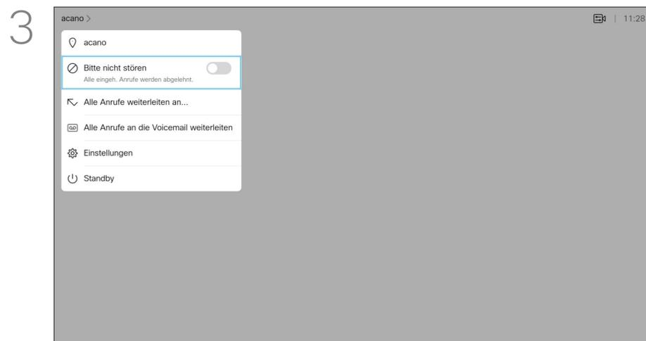
Verwenden Sie die **Pfeiltasten** auf der Fernbedienung, um zu *Bitte nicht stören* zu navigieren, und verwenden Sie die **OK-Taste** auf der Fernbedienung, um die Funktion „Bitte nicht stören“ zu aktivieren oder zu deaktivieren.
