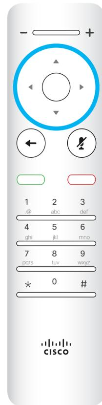
Für die **Feldauswahl/Cursor**-Tasten verwenden Sie die äußeren Tasten im runden Feld (**Links/Rechts/Oben/Unten**).
