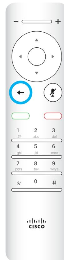
Mit der linken runden Taste gehen Sie **Einen Schritt zurück**.
