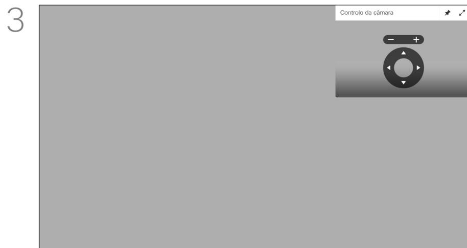
3 Pode agora ajustar o pan, zoom e tilt da câmara. Utilize os controlos **Aumentar/Diminuir** do controlo remoto para ajustar o zoom e as teclas do **Cursor** para ajustar o pan e tilt.
