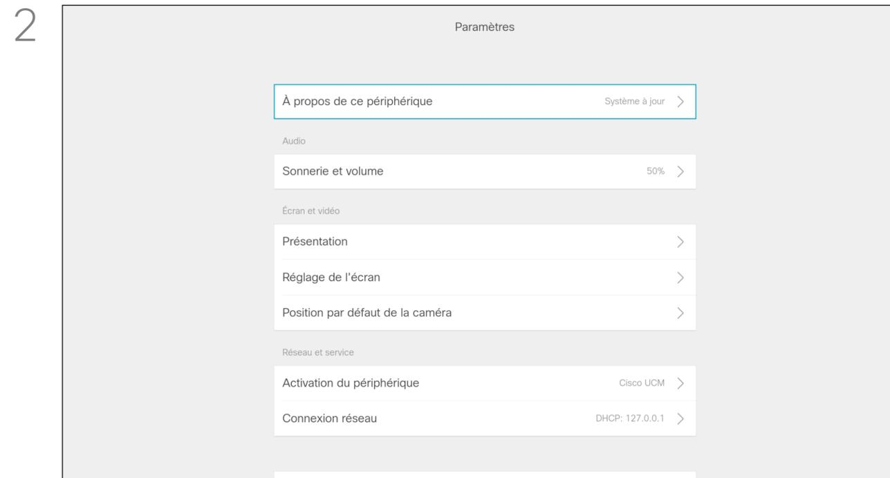
Les *Paramètres* fournissent des informations sur le système et permettent d'accéder à l'Assistant de configuration et de forcer le redémarrage du système.
