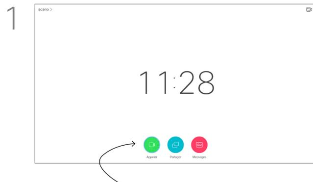
1 Vérifiez que l'icône **Appeler** (située à l'extrême gauche, au bas de l'écran) est sélectionnée et appuyez sur **OK** ou sur le bouton **Appeler** vert de la télécommande.
