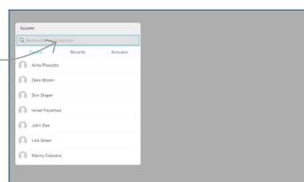
3 Pour saisir des chiffres, appuyez sur les touches de la télécommande. Pour utiliser le clavier virtuel, naviguez vers le bas jusqu'au clavier et sélectionnez des caractères. Appuyez sur **OK** pour sélectionner un caractère.
