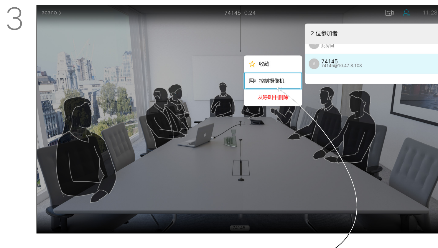
3 要控制远端摄像机，请导航到摄像机（右起第二），然后单击遥控器上的确定。
