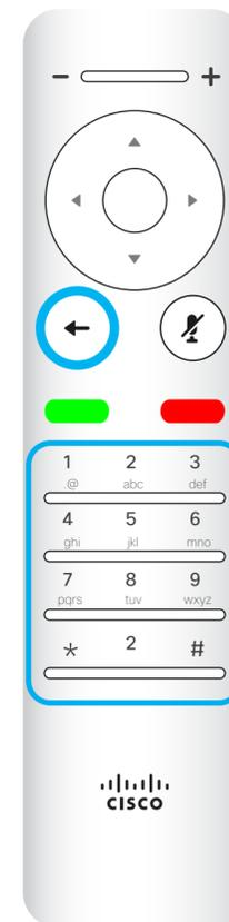
Le **clavier** permet de composer un numéro ou de saisir des chiffres. Une petite bosse apparaît en relief de la touche 5 pour faciliter l'identification des touches.
