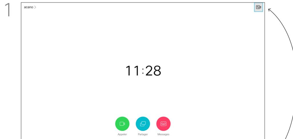
Lors d'un appel ou hors d'un appel (comme illustré ici), déplacez le curseur jusqu'à l'angle supérieur droit, sur l'icône *Caméra*. Appuyez sur le bouton **OK** de la télécommande.
