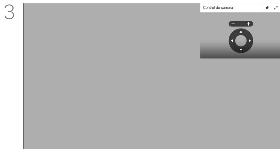
3 Ajuste los valores de panorámica, zoom e inclinación de la cámara. Utilice los controles **Aumentar/Reducir** del control remoto para ajustar el zoom y luego las teclas de **dirección** para ajustar la panorámica y la inclinación.
