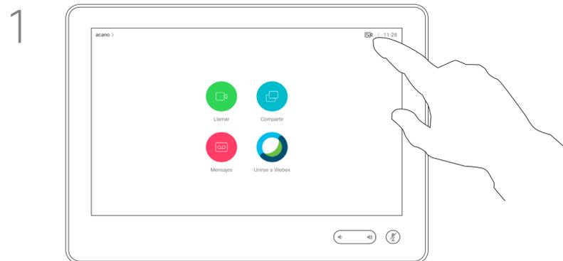
Para activar la función de seguimiento del orador, toque **Cámara** en la esquina superior derecha.
