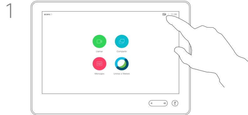
1 Toque **Cámara** para abrir el menú de ajustes de la cámara.
