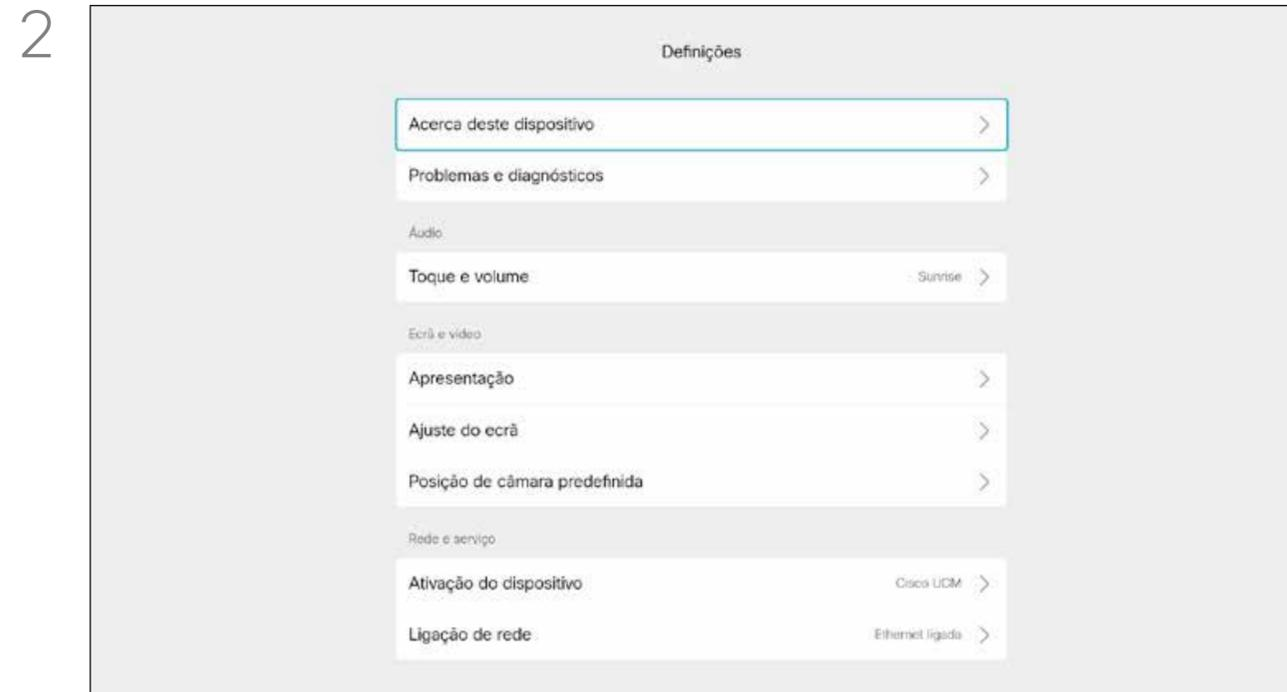
As *Definições* apresentam informações básicas sobre o sistema e fornecem acesso ao Assistente de configuração e a capacidade de forçar o reinício do sistema.
