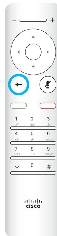
A ação **Retroceder um passo** é realizada através da tecla circular esquerda.
