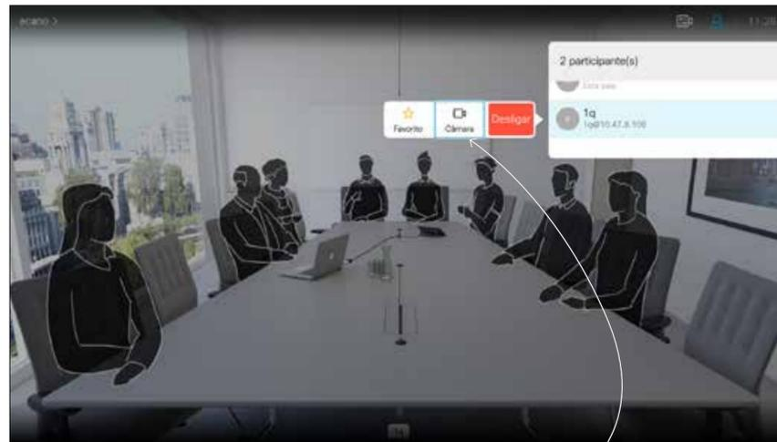
Para controlar a câmara remota navegue até *Câmaras* (número dois a contar da direita) e clique em **OK** no controlo remoto.
