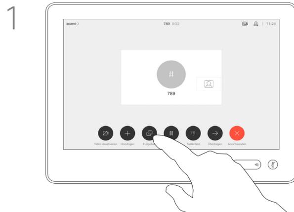
1 Verbinden Sie die Quelle mit einem geeigneten Kabel mit dem Videosystem, stellen Sie sicher, dass es eingeschaltet wurde, und tippen Sie auf **Freigeben**.
