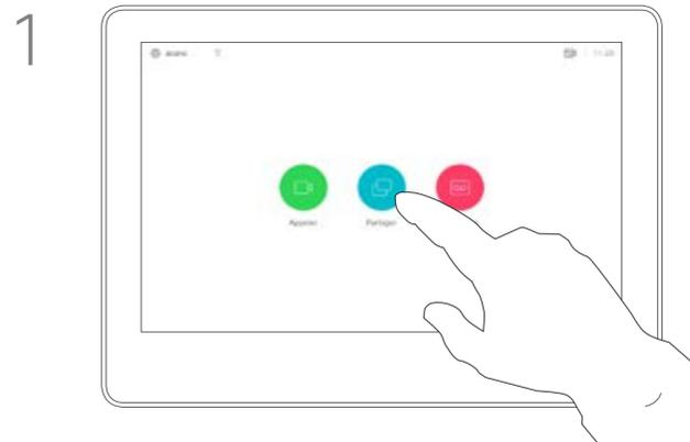
Connectez l'appareil source au système vidéo via un câble approprié, veillez à ce qu'il soit allumé et effleurez **Partager**.
