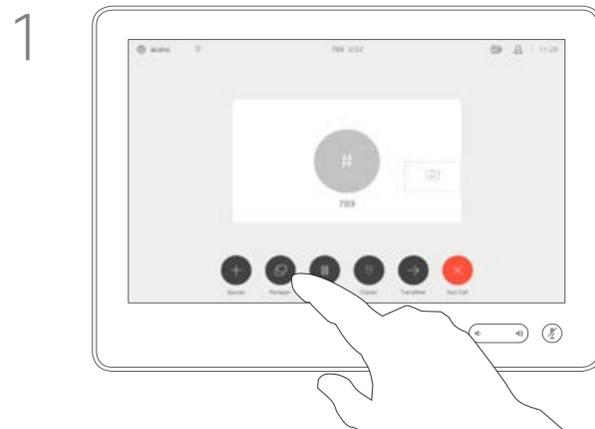
Connectez la source au système vidéo via un câble approprié, veillez à ce qu'elle soit allumée et effleurez **Partager**.
