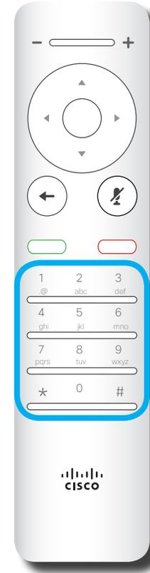
Das **Tastenfeld** wird zum Wählen oder Eingeben von Zahlen verwendet. Auf der Ziffer 5 befindet sich eine Erhöhung, um die Tasten zu identifizieren.
