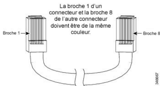
Illustration 54 : Identification d'un câble croisé
