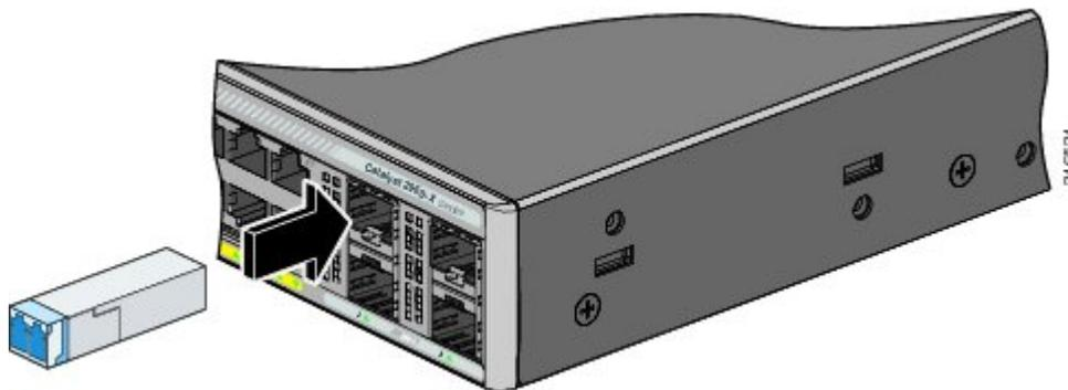
**Étape 2** Insérez le câble approprié dans le port de module. Insérez l'autre extrémité du câble dans l'autre périphérique.
