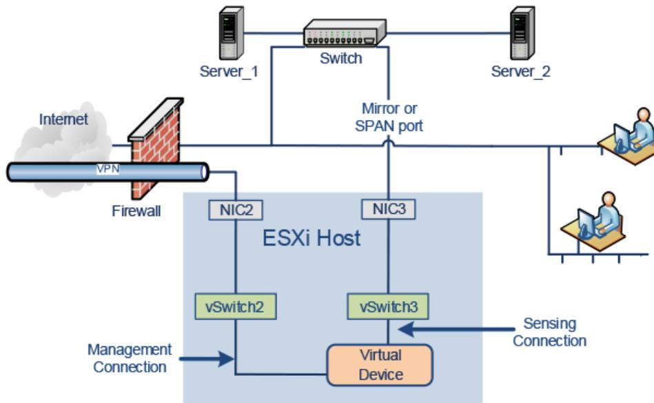
네트워크 트래픽을 모니터링하려면 가상 디바이스의 센싱 연결을 허용해야 합니다. 그러려면 센싱 인터페이스가 연결된 가상 스위치 또는 포트 그룹에서 무차별 모드 트래픽을 허용해야 합니다. 그럴 경우 가상 디바이스가 다른 장비 또는 네트워크 장비로 보내는 패킷을 읽을 수 있습니다. 이 예에서는 모든 vSwitch3가 무차별 모드 트래픽을 허용하도록 설정되어 있습니다. vSwitch3도 NIC3을 통해 SPAN 포트에 연결되어 있어 원격사무실의 스위치를 통과하는 트래픽을 모니터링할 수 있습니다. 3-9페이지의 가상 기기 인터페이스 구성을 참조하십시오.
