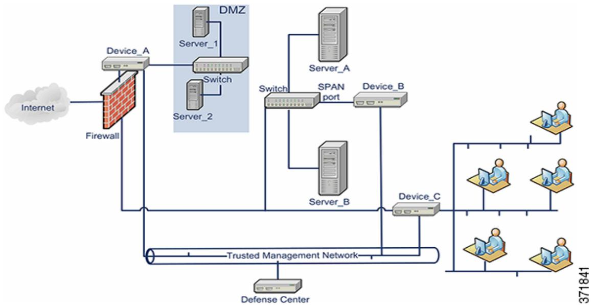
대부분의 네트워크 스위치에서 포트 미러링을 구성하여 한 스위치 포트(또는 전체 VLAN)에서 볼 수 있는 네트워크 패킷의 복사본을 네트워크 모니터링 연결로 전송할 수 있습니다. 포트 미러링은 주요 네트워크 장비 제공업체에서 SPAN(Switch Port Analyzer)이라고도 하며 네트워크 트래픽 모니터링 기능을 제공합니다. 디바이스 B는 서버 A와 서버 B 사이의 스위치에 있는 SPAN 포트를 통해 서버 A와 서버 B 사이의 트래픽을 모니터링합니다.
