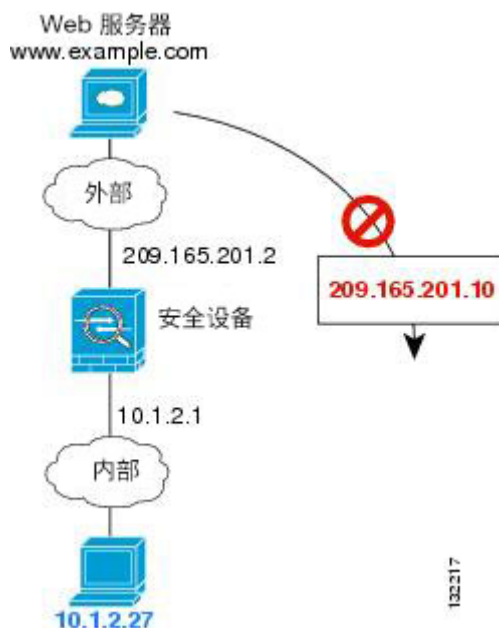
图 32: 远程主机尝试向映射地址发起连接
