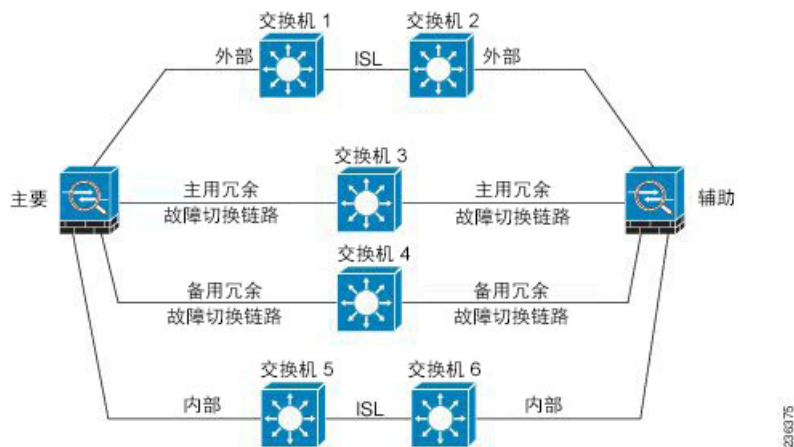
图 14: 使用交换机间链路连接
