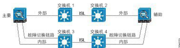
图 12: 使用安全交换机连接
