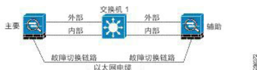
图 11: 通过电缆连接
