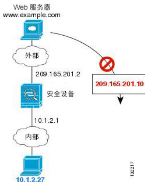
图 26: 远程主机尝试向映射地址发起连接
