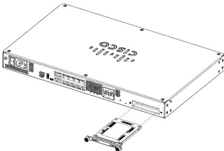
Figura 23: Remover e instalar um SSD
