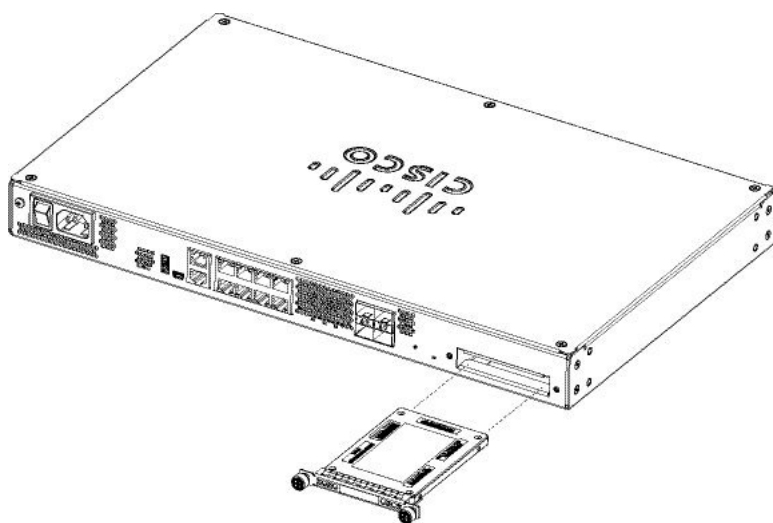
Figura 23: Extracción e instalación de una SSD
