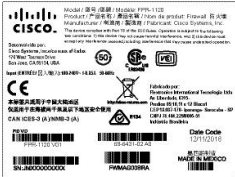
Figura 3: Etiqueta de conformidad en el chasis de Firepower
