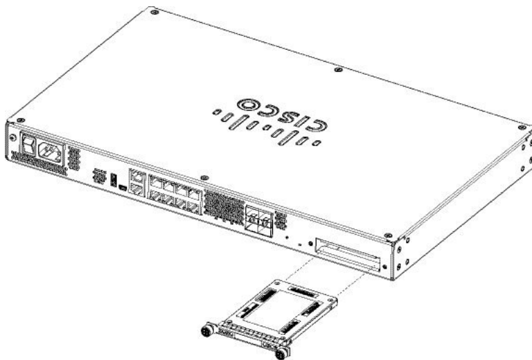
Abbildung 23: Entfernen und Installieren einer SSD
