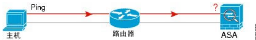
图 81: IP 寻址问题引发的 ping 故障
